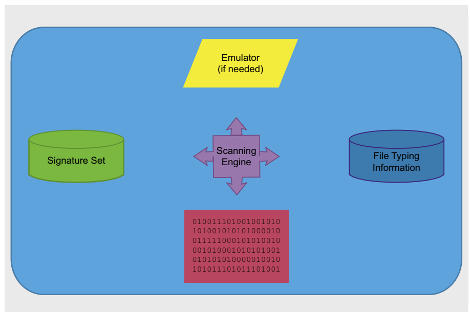
Figure 4. Major AV Engine Components
